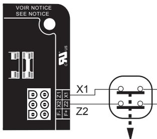
El corte de la excitación se produce mediante el corte de la alimentación del regulador (1 hilo en cada bobinado auxiliar); calibre de los contactos 16 A - 250 V alt. Conexión idéntica para rearmar la protección interna del regulador.
