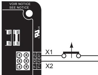
El corte de la excitación se consigue mediante el corte de la alimentación del regulador. (1 hilo - X1 o X2).
