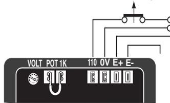
El corte de la excitación se obtiene interrumpiendo la alimentación del regulador (1 hilo -0 ó 110V).
